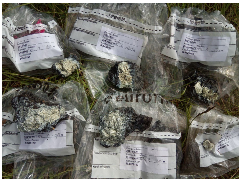
Figur 11 Asfaltsprover sprayade med asfaltsspray
