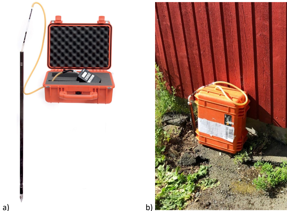
Figur 9 a) Utrustning för porgasprovtagning (Foto: Eurofins Pegasuslab) b) Porgasprovtagning i punkt G2138
