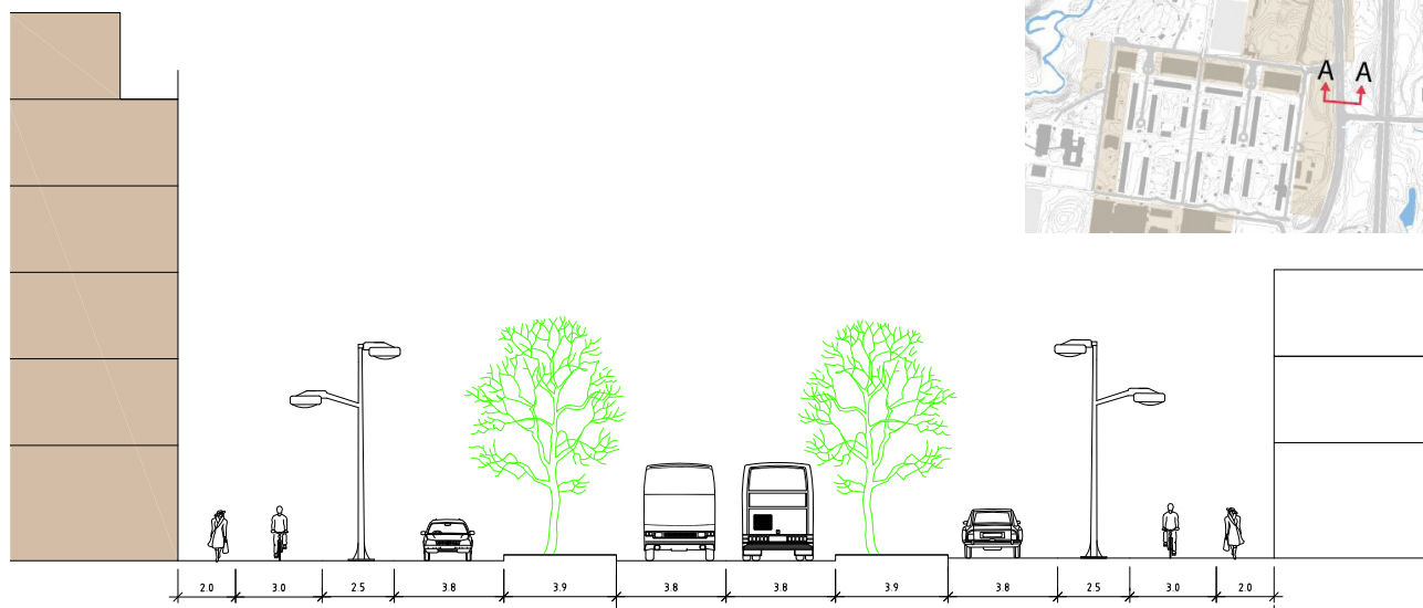
Sektion A-A: Förslag till sektion över Värnamovägens norra del. Sektionen visar hur gatan kan omvandlas i framtiden.
