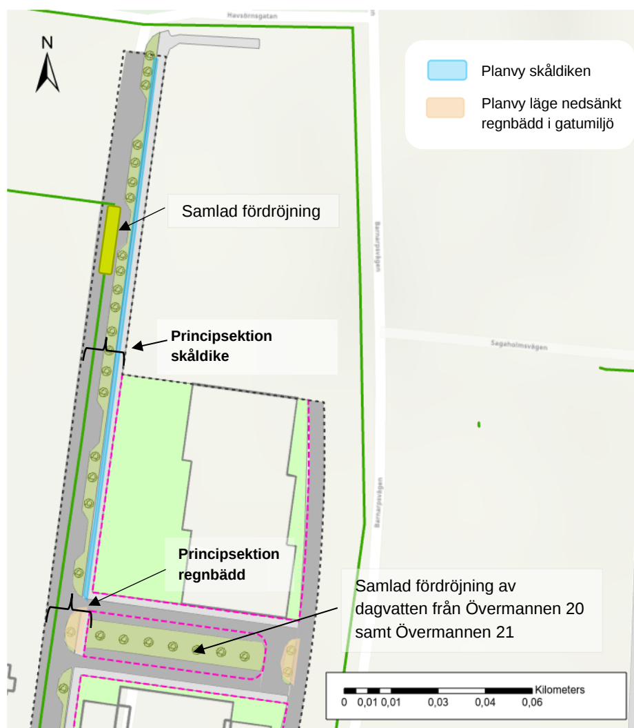
Figur 15. Översikt för åtgärder i allmän platsmark.
