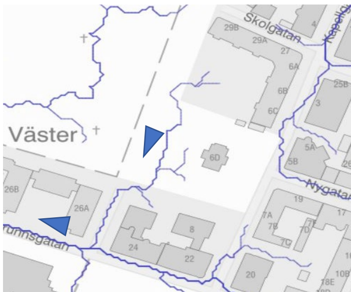
Rinnvägar för ytvatten enligt befintliga markhöjder
