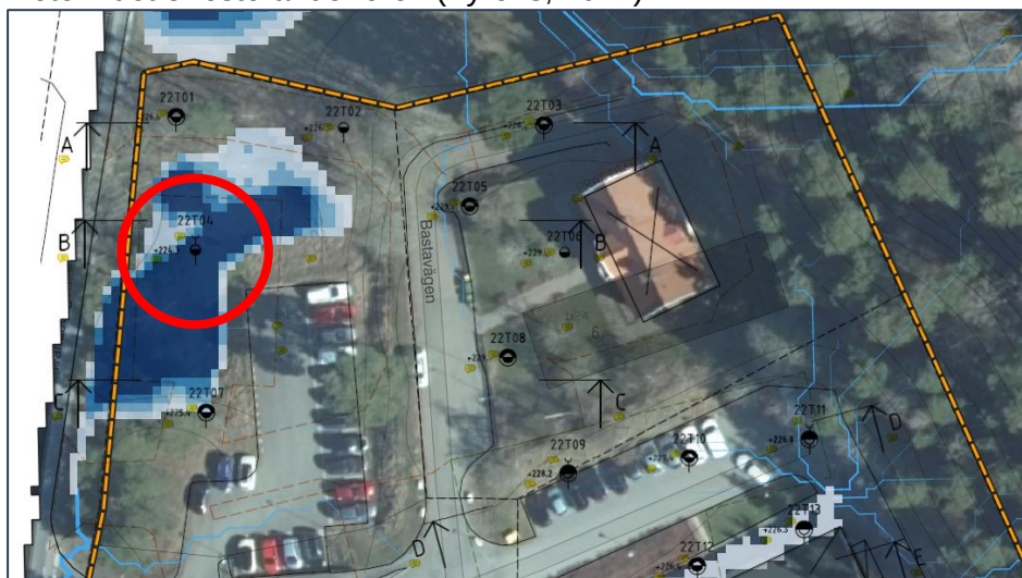
Figur 7. Lågpunktskartering med pålagt utklipp från Tyréns geotekniska undersökning (transparenta kartbild med svarta linjer). Vid inringad provpunkt (22T04) återfanns grundvatten cirka 3 meter under markytan (i den befintliga lågpunkten vid parkeringen)
