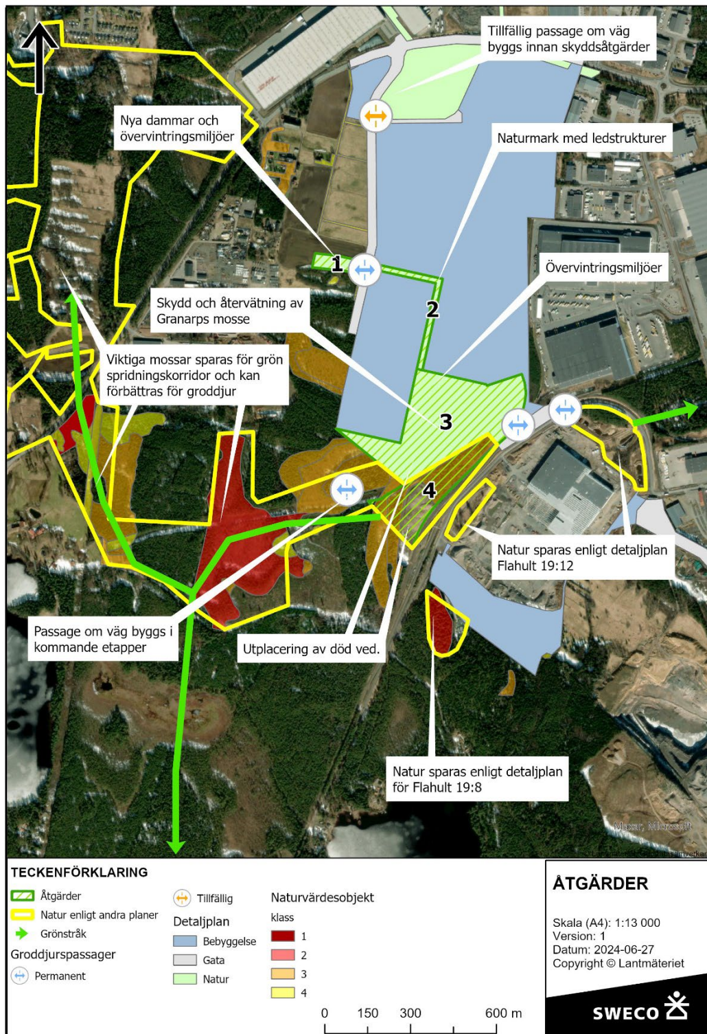
Figur 18. Översiktlig bild som förklarar principen av skydds- och kompensationsåtgärder. Grönstråken följer intentionerna i planprogrammet för Målö ångar och Målön. Stråket går bland annat genom den så kallade Ömossen (høgt NVI-värde) i riktning söderut mot Suttersjöarna. Den södra gröddjurspassagen är inget krav för detaljplanen eftersom den är anpassad till eventuell utbyggnad av väg inom planprogrammet.
