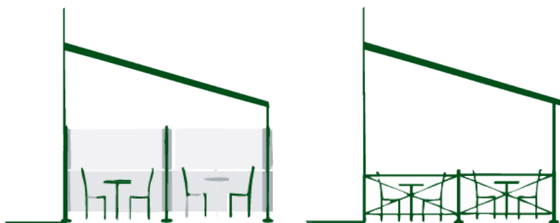
Figur 1 Illustration som visar exempel på uteservering med konstruktioner som inte är bygglovspliktiga; Höj- och sänkbara glaspartier, staket, utfällbara markiser samt utfällbara markiser med en smal/tunn stöttepelare. Inget får fästas i markbeläggningen.
