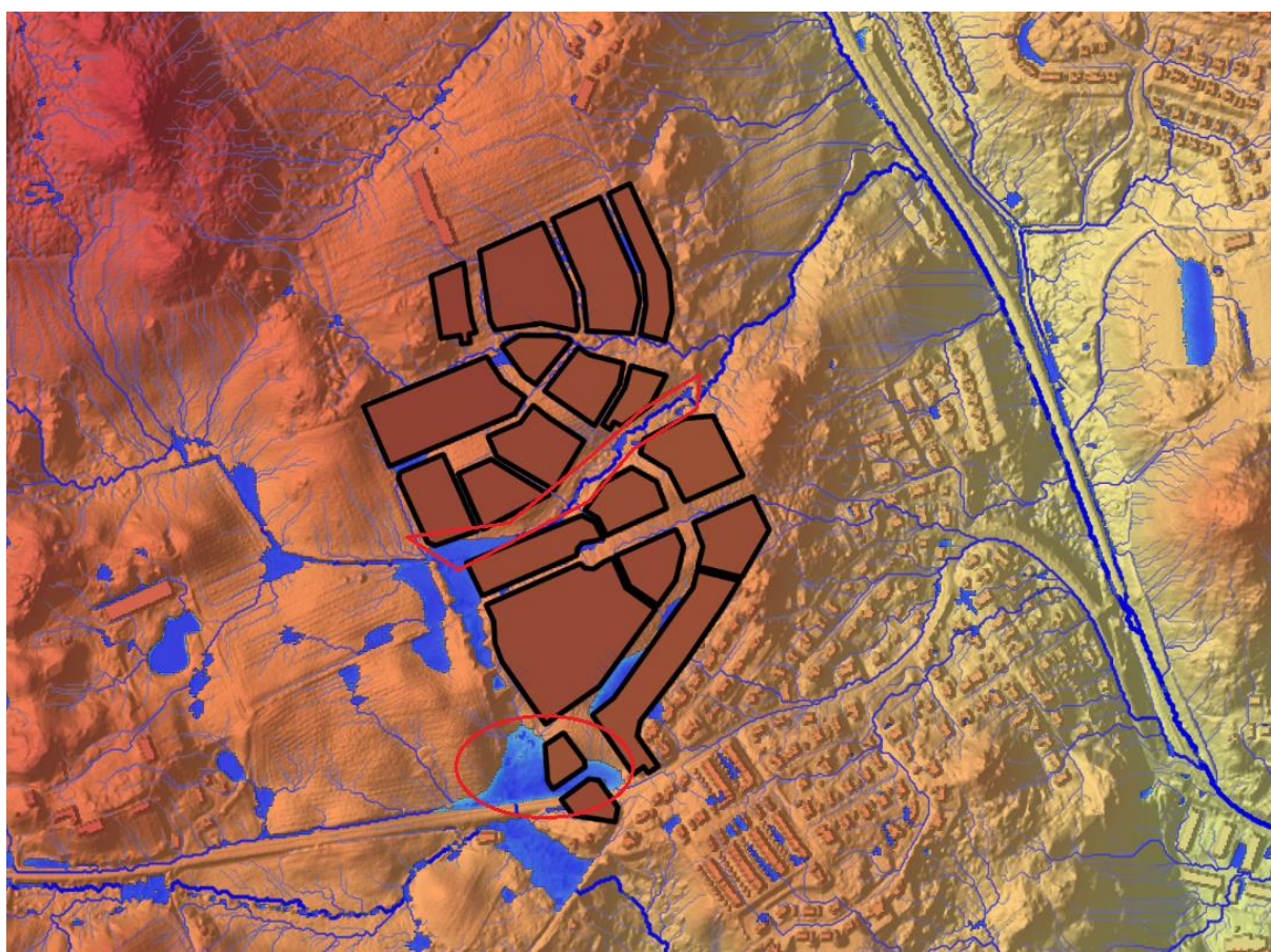
Figur 7-2. Lågpunktskartering vid ett 100-årsregn inom planområdet Åsen genomförd med SCALGO Live med planerade byggnader. Områden inom röd linje visar översvämningszoner som behöver utnyttjas.
