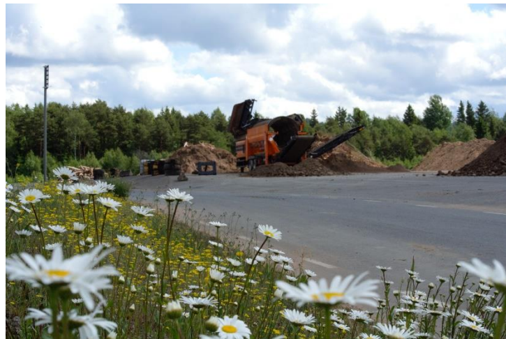
Sorteringsverk för blandning av jordprodukter. Komposten tillsätts i blandningen.
