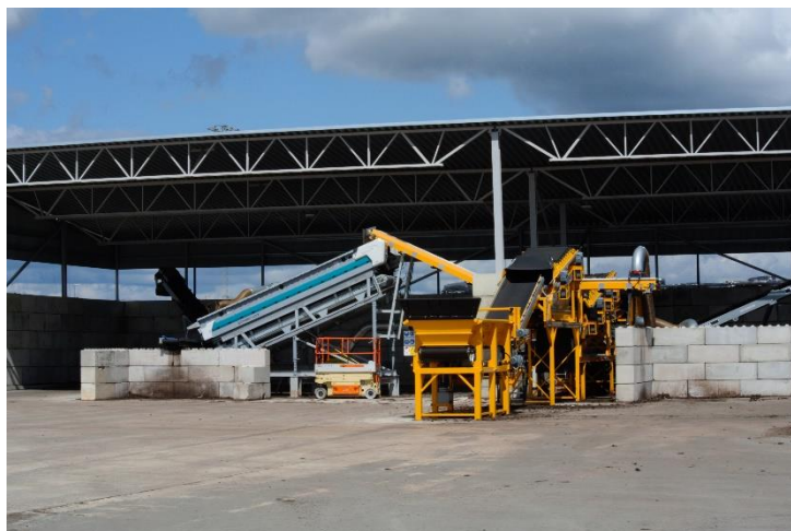
Sorteringsmaskiner sorterar presskaka till kompost.
