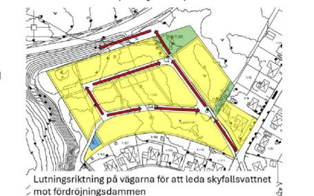
Lutningsriktning på vägarna för att leda skyfallsvattnet mot fördröjningsdammarna
