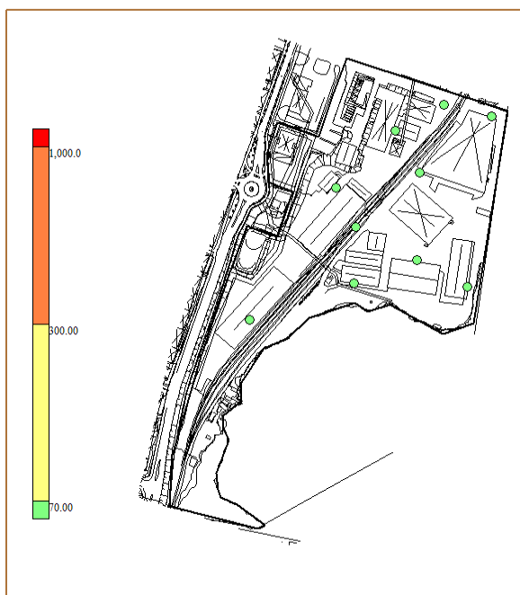
Figur 6 Översikt över provtagningspunkter för asfalt. Färgskalan anger uppmätt halt PAH16 (mg/kg TS) i dessa asfaltprover
