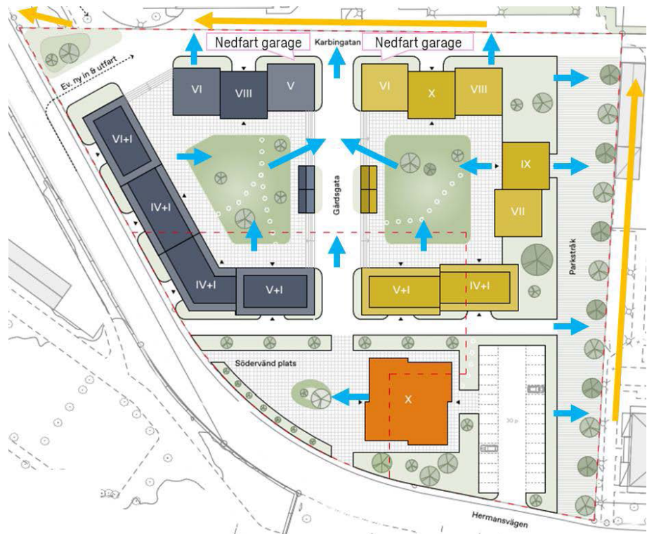
Figur 12. Bilden visar förslag på hur dagvattnet leds ut till det kommunala nätet.
