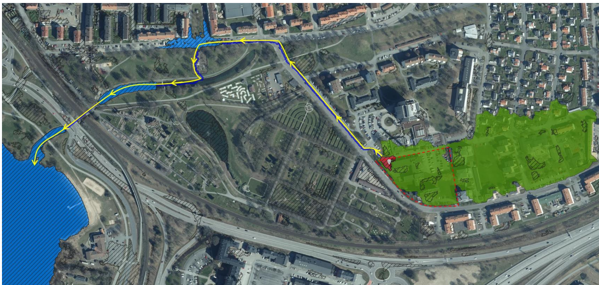
Figur 9: Större flödesvägar vid skyfall (gula pilar) från planområdet (markerat i rött) samt tillhörande avrinningsområde uppströms (markerat i grönt).
