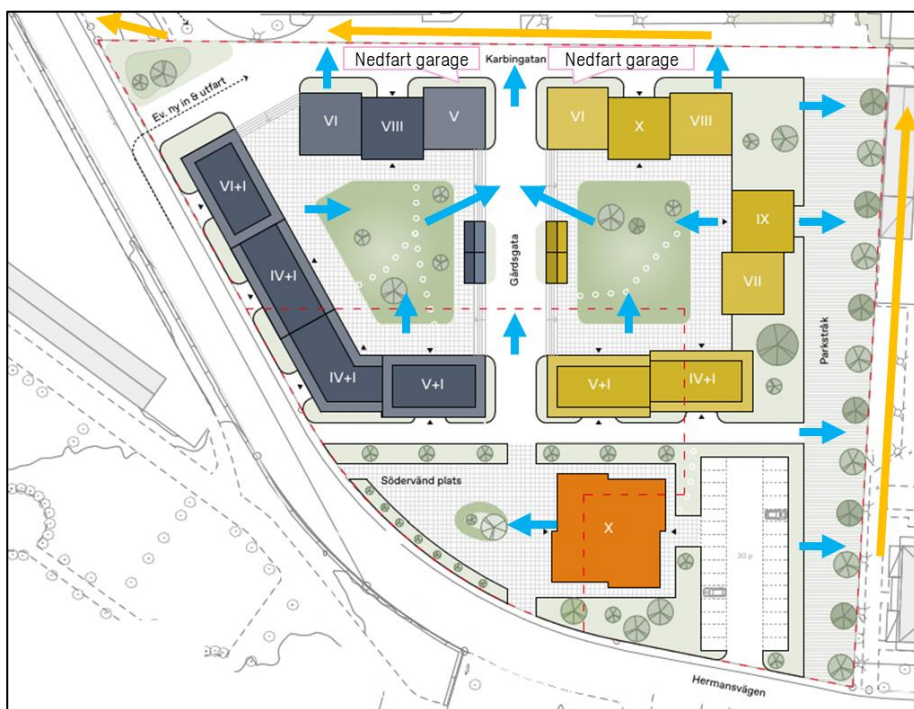
Figur 10: Sekundära avrinningsvägar för planerad bebyggelse inom planområdet (blå pilar) och utanför planområdet (orangea pilar).
