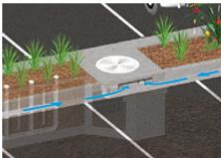
Figur 9. Modular Wetlands, inlopp via trottoarkant. Bild hämtad från www.milford.dk 2018-10-03.
