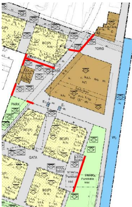
Figur 27. Placering av möblering i trafikmiljö som avgränsar mot torg och parkytor (indikerat med rött). Bedömning gjort av Jönköpings kommun.
