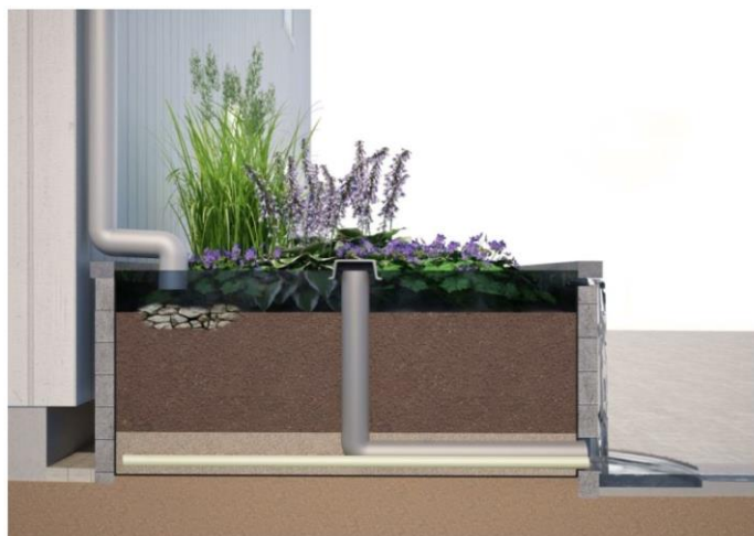
Figur 10 Biofilter med tät duk under makadamlagret och upp på sidorna (Kent Fridell & Kristian Klasson Tengbomgruppen AB, 2014).
