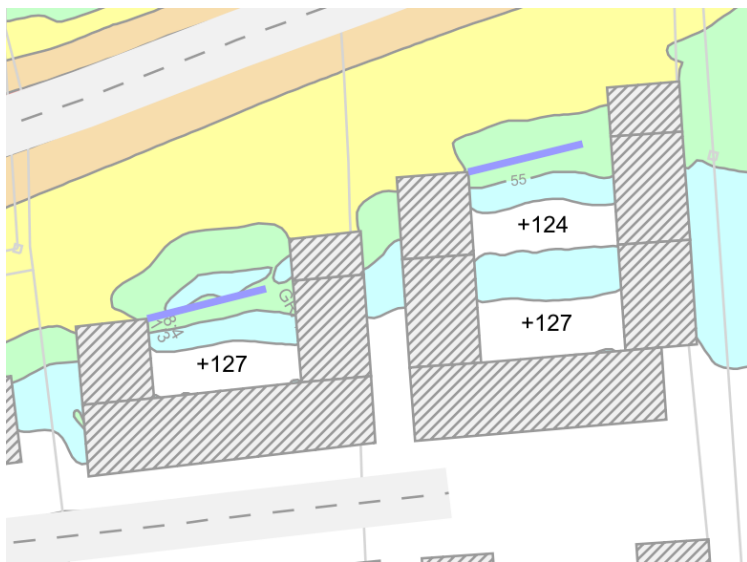
Figur 5. Plushöjder för terrasseringen som använts i beräkningen.
