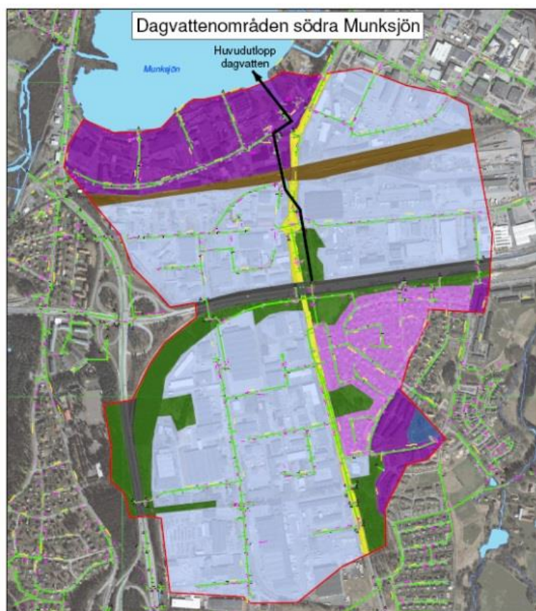
Figur 7. Avrinningskoefficienter för anslutande ytor: lila = 90 %, ljuslila = 40 %, vägar = 90 %, grå = 90 %, grön = 30 %.
