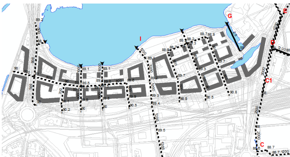
Figur 11. Ledningsdimensioner och vattengångar i område 2 Skeppsbron, enligt alternativ 2.
