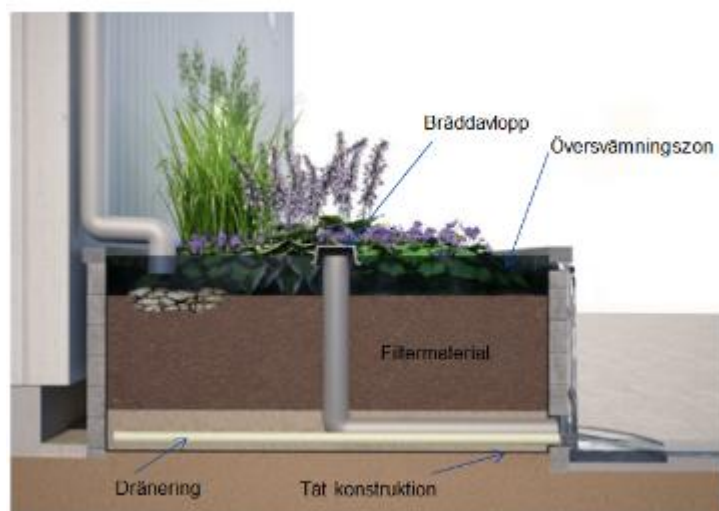
Figur 13: Skiss över en växtbädds uppbyggnad för att hantera takdagvatten Källa: Inventering av dagvattenlösningar för urbana miljöer. VINNOVA 2014. Kent Fridell & Kristian Klasson. Tengbomgruppen.
