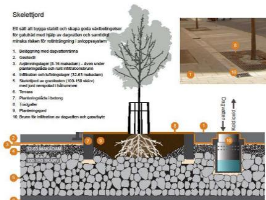
Figur 9: Exempel på uppbyggnad av skelettjord (Örjan Ståls föredrag "Träd och dagvatten" på Rörnätskonferensen i Malmö 1-2 april 2014).
