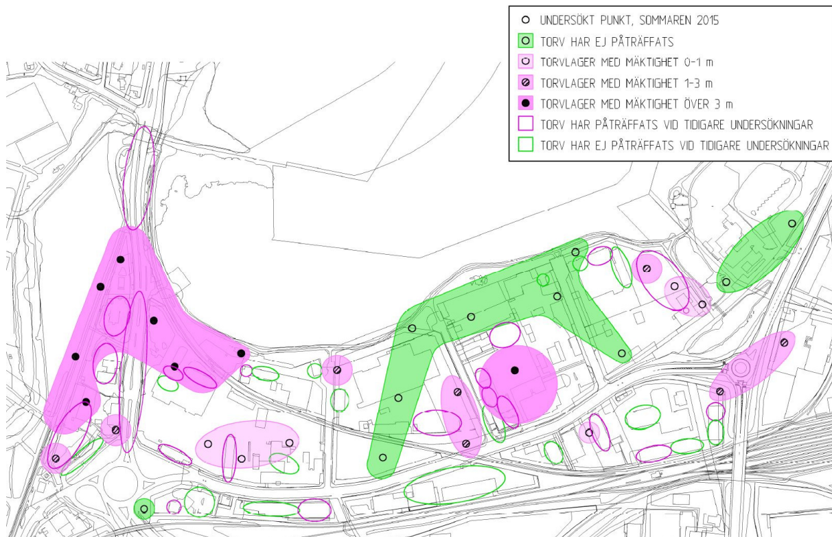
Figur 5-2 Schematisk redovisning av områden där torv påträffats vid utförda undersökningar
