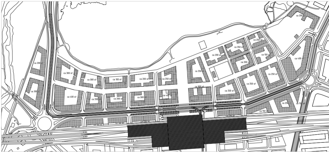
Figur 9. Antaget antal pålar per kvarter, utdrag från ritning G-10-1-041
