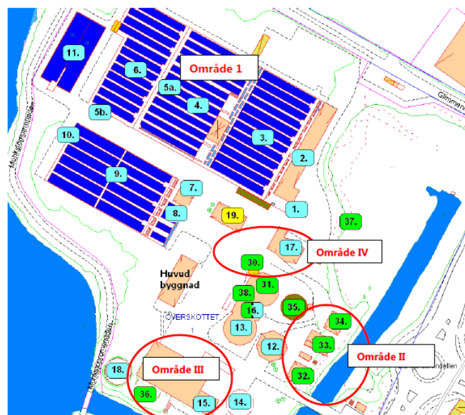
Figur 4: Utsläppskällor indelade i fyra delområden. Källorna i varje område sammanförs och släpps ut genom 4 separata skorstenar.
