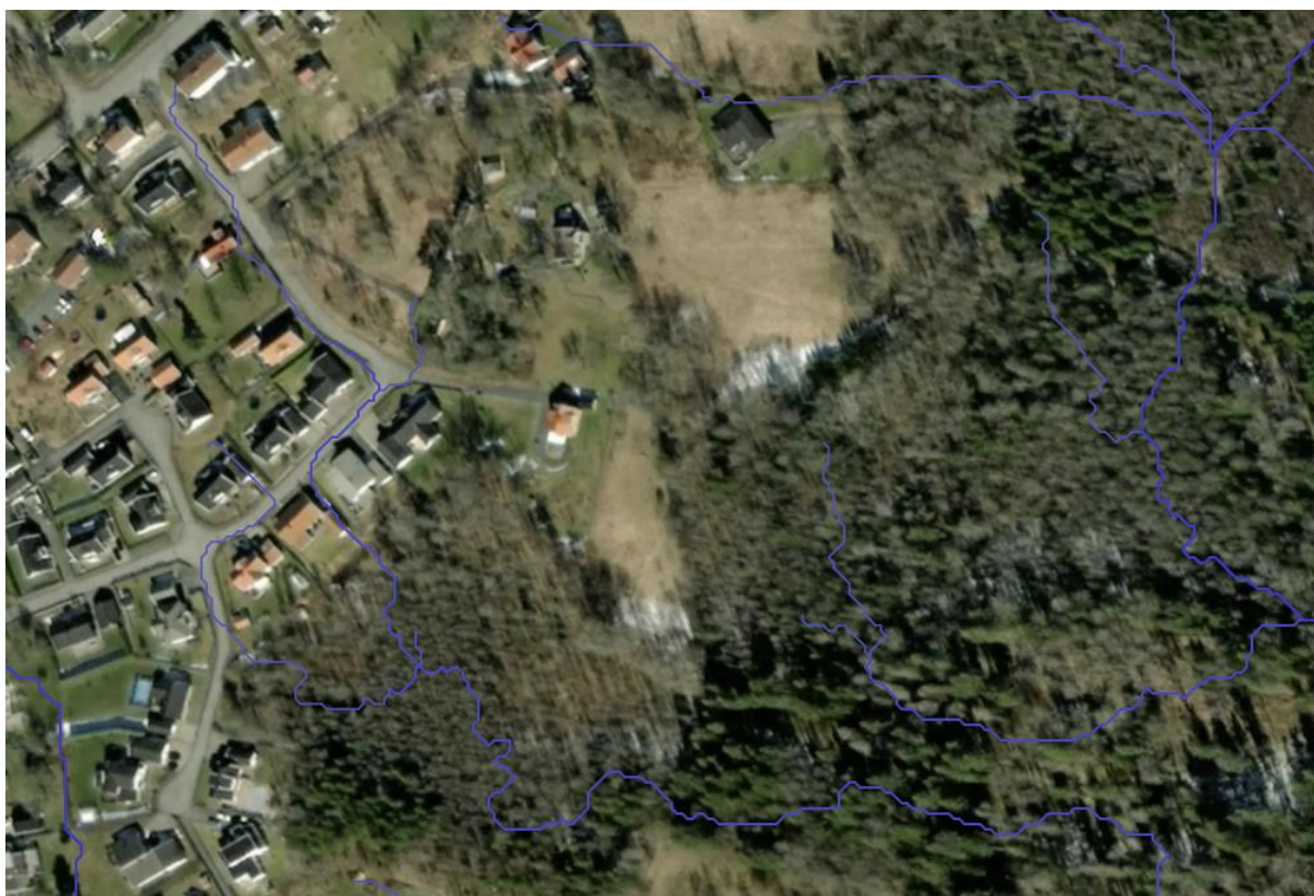
Figur 12. Rinnväg för skyfallsvatten på 1:9
