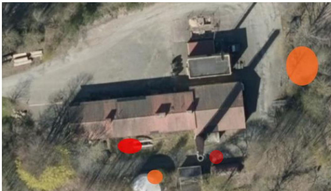
FIGUR 3 UNGEFÄRLIGT LÄGE FÖR FÖRORENINGAR ÖVER KM (ORANGE) OCH MKM (RÖD) (NORR ÅT HÖGER I BILD)
