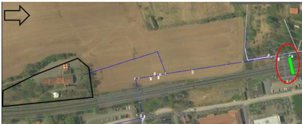
Figur 8. Befintlig dagvattenkylvert under Ebba Ramsays väg. Blå linjer avser befintliga dricksvattenledningar.
