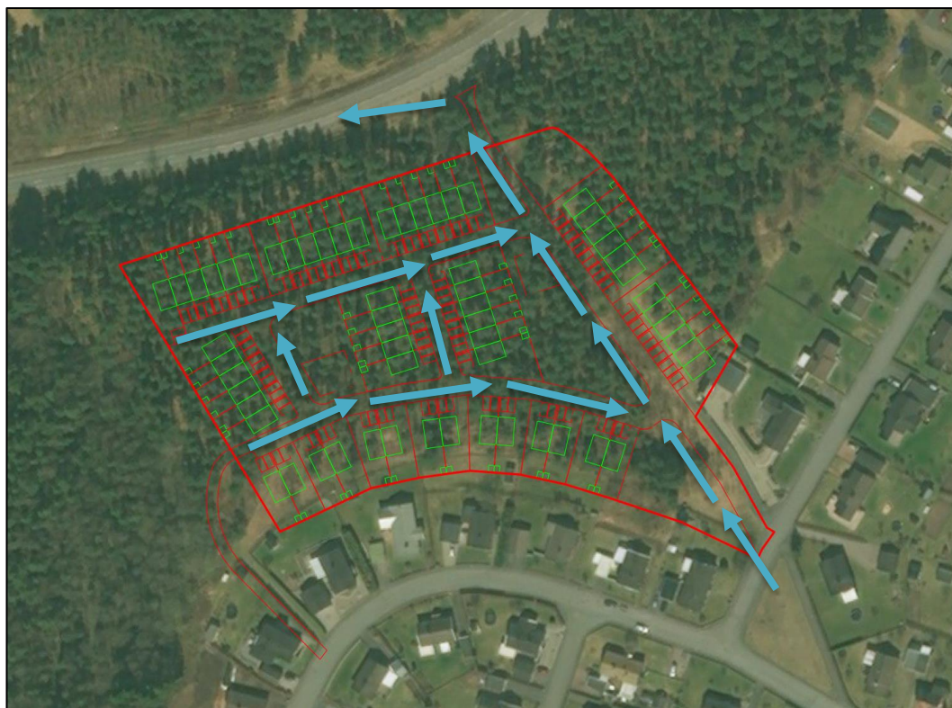
Figur 22. Förslag på hur dagvattnet bör avledas ytligt inom planområdet vid skyfallsregn. Vatten rekommenderas att brädas mot Kortebovägen i norr. Blå pilar visar yttlig avrinning.
