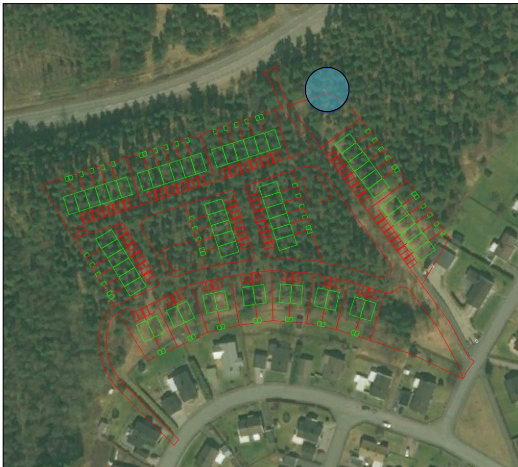
Figur 15. Föreslagen yta lämplig för torr damm. Utformas dammen enligt förslag behöver dess area vara cirka 440 m 2 .
