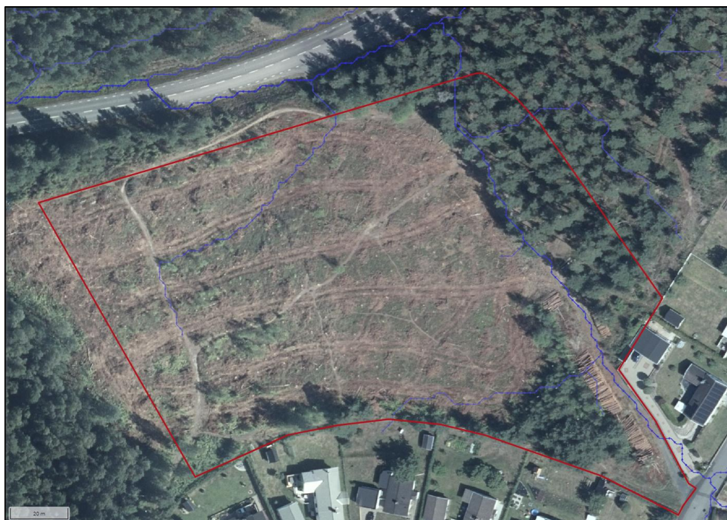
Figur 5. Befintlig riktning av yttligt dagvattenflöde inom och i angränsning till planområdet (Scalgo, 2020).
