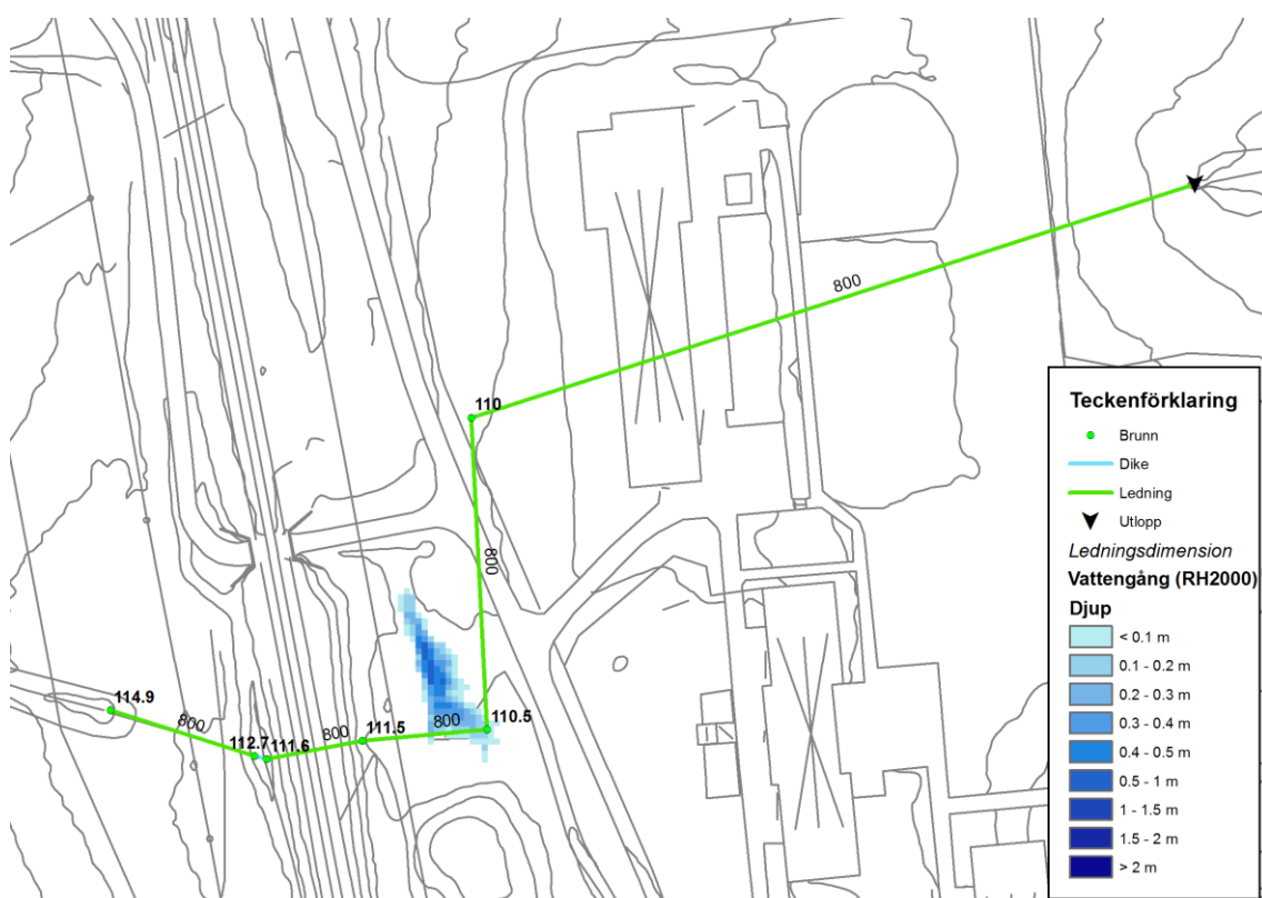
Figur 20. Vid 30-årsregnet spiller vatten ut i en lågpunkt på östra sidan om järnvägen men tar sig inte vidare till kringliggande områden.
