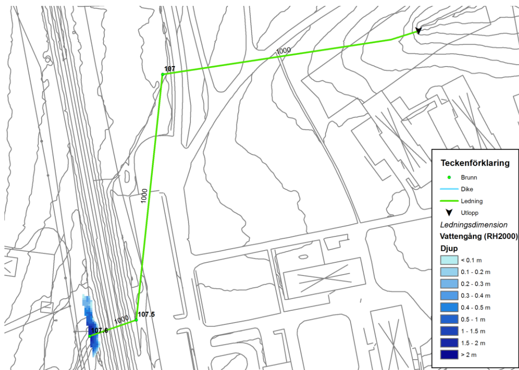
Figur 24. Vid 30-årsregnet dämmer vatten upp i inloppet till kulvert 2 i diket på västra sidan om järnvägen.
