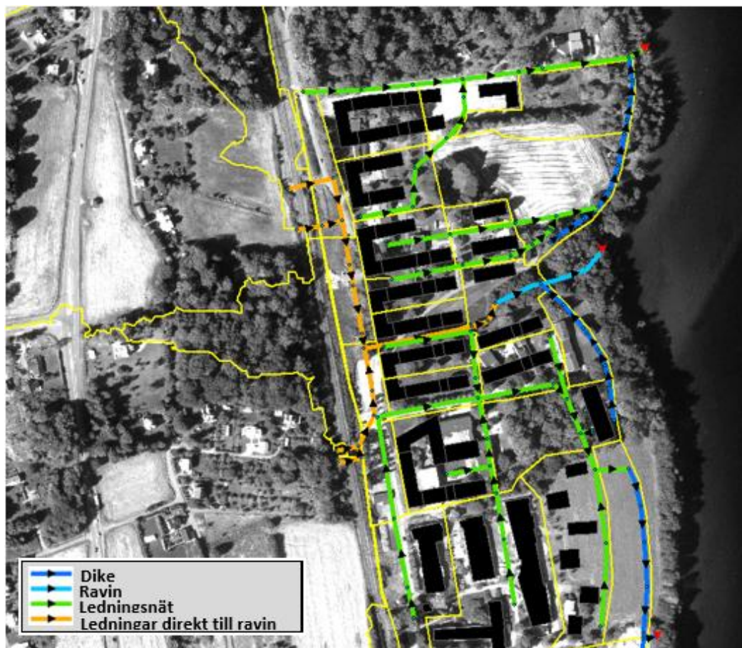
Figur 5. Översikt över tidigare föreslaget dagvattensystem, som använts för skyfallsberäkningen. Gul linje visar delavrinningsområdesgränser.
