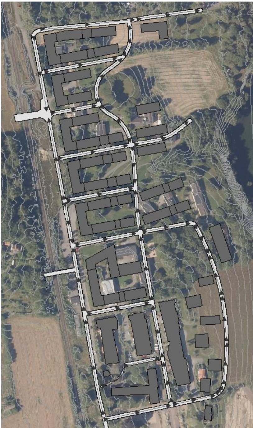
Figur 7. Översikt ytliga vattenvägar (svarta pilar) vid nederbörd och skyfall, samt markens lutning (grå linjer).
