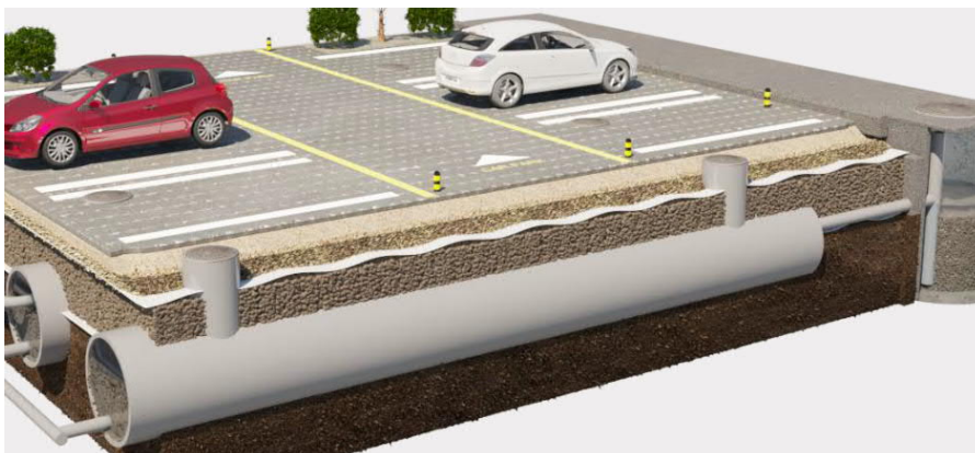
Figur 17. Exempel på fördröjning och rening i rörmagasin. Bildkälla: Wreco AB
