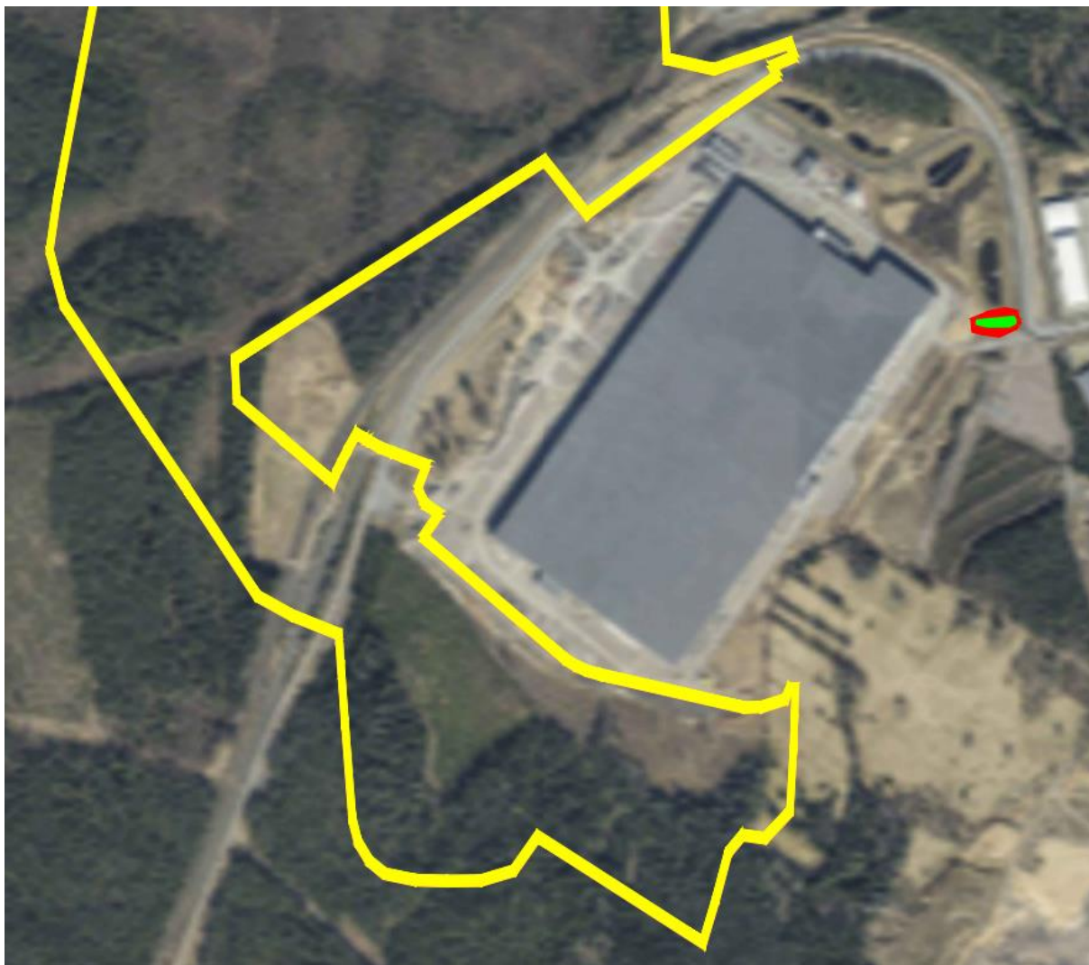
Figur 13. Ytanspråk och föreslagen ungefärlig placering av fördröjningsdammen för delområde 6. Röd polygon visar dammens yta med genomsnittsdjup på 1 m och grön polygon för 2 m. ungefärlig planområdesgräns i gult. Dammen för rening syns i bild norr om den gröna och röda pollygonen.
