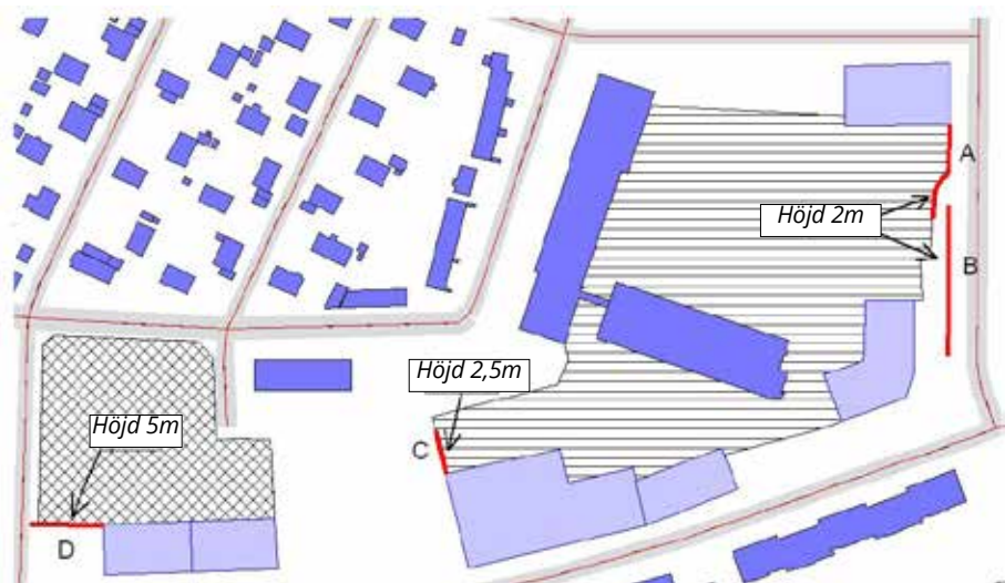
Bild 21. Visar framtidsenaria där nya byggnader 1,2,3 tillsammans med skärmar A, B, C, D ger bullerreducerand avskärmning.
