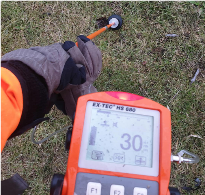
Figur 1. Mätning vid markytan med munstycke försett med tratt. Vid bildtillfället uppmäts 30 ppm metan. Foto: Ida Arvidsson, Sweco.
