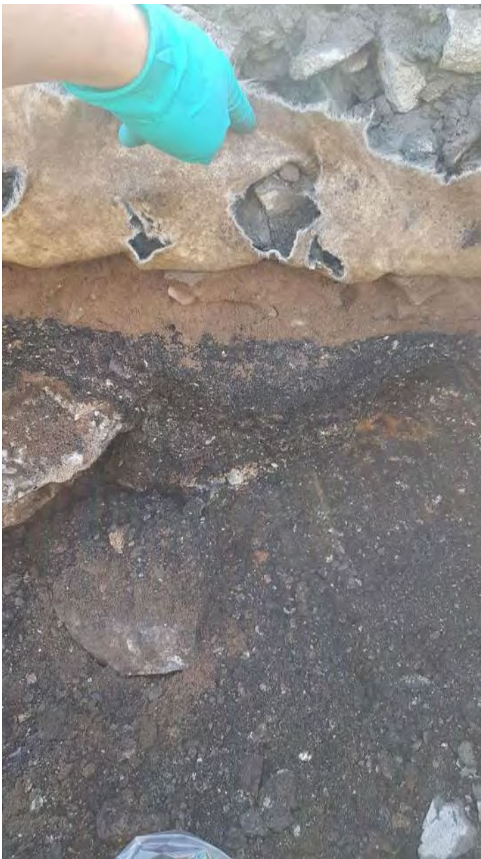
Figur 6. Provgrop SW1811 vid bef. parkeringsplats. Djup 1 m. Översta halvmetern bestående av bärlager, markduk och underliggande svart material (bitumen?). Underliggande halvmetern fortsatt svart material, block, sten, järnslag. Gick inte att gräva djupare pga. block/betong.
