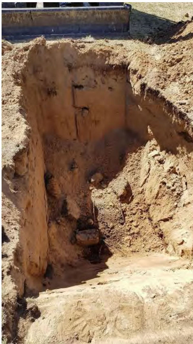
Figur 1. Provgrop SW1805. Djup ca 2 meter i sand. Sista halvmeteren rasade igen pga. befintliga betongplattor och armeringsjärn. Även spår av tegel och blåbetong översta metern.
