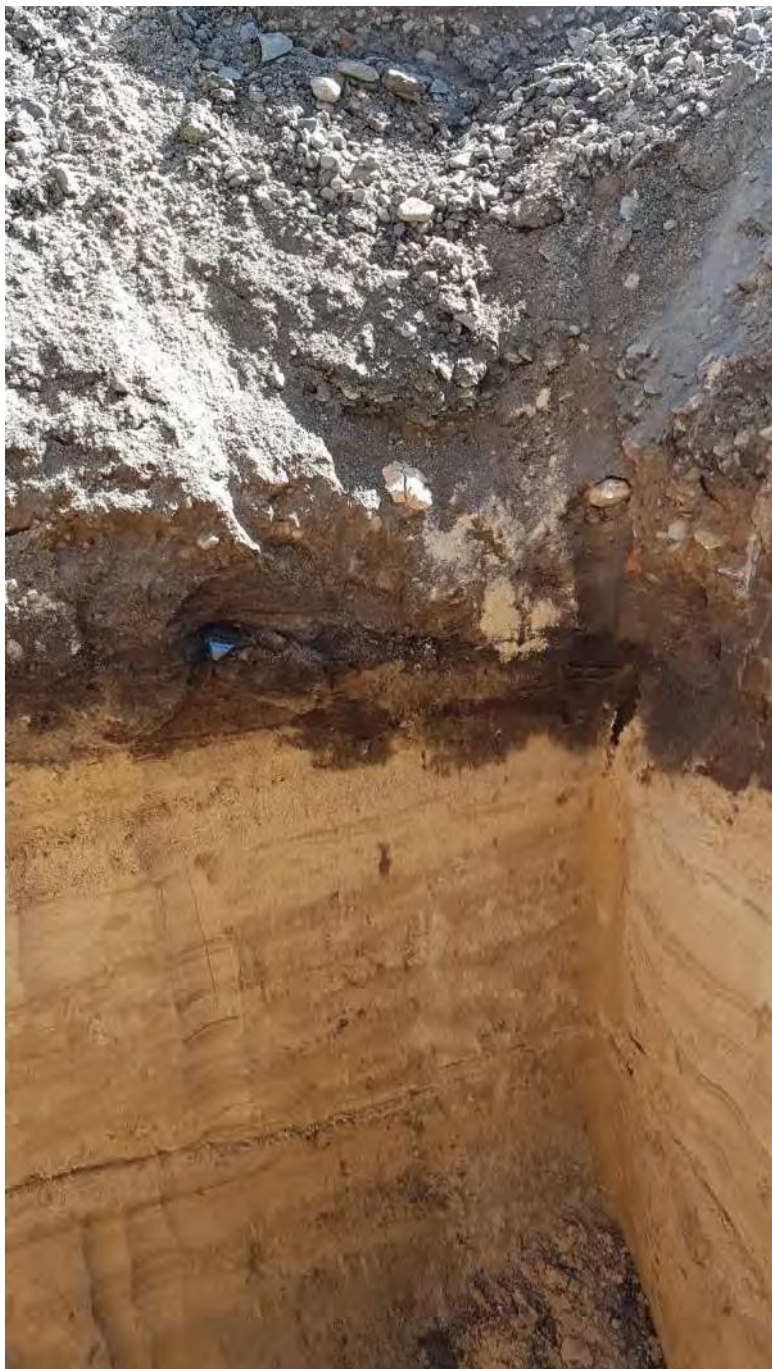
Figur 3. Provgrop SW1807 vid bef. parkeringsplats. Djup 1,4 m. Översta halvmeterna bärlager/fyll med tegelrester. Sand ner till 1,4 m. Grundvatten påträffades runt 1,8 m.
