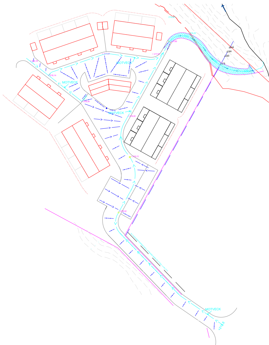
Bild från dagvattenutredningen som visar föreslagna flödesriktningar vid skyfall och höga flöden Av: Detectum AB
