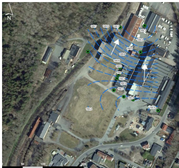
Strömning av grundvatten vid Norrahammars bruk
