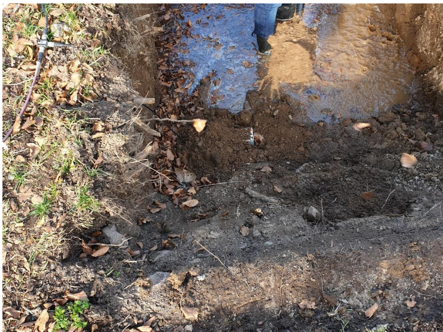
Figur 5 Givaren i MP 1:2 monterad och placerad i våg i schaktgropen, delvis täckt med jord. Under mätningen var mätaren helt täckt med jord.
