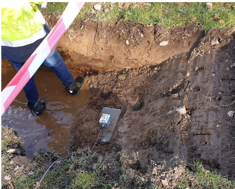
Figur 6 Givaren i MP 1:3 monterad på trädgårdsplatta, placerad i våg och delvis täckt med jord. Under mätningen var hela mätaren övertäckt med jord.
