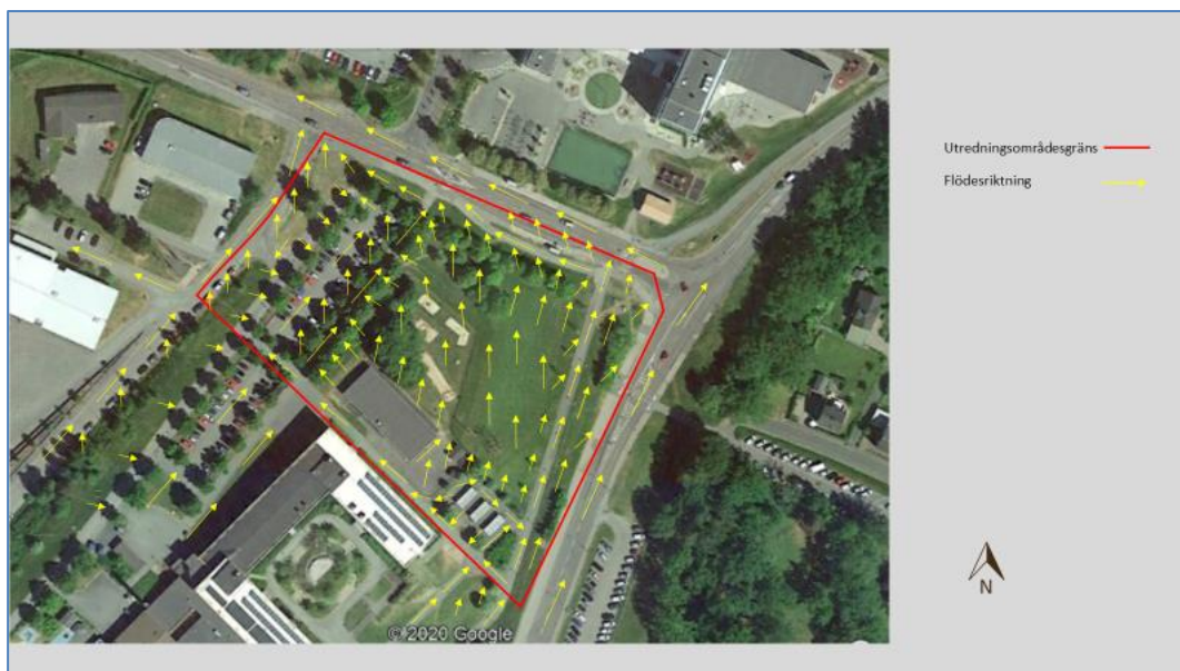
Figur 3:4. Karta över dagvattnets flödesriktningar vid ytavrinning. Röd markering visar utredningsområdets gräns och gula pilar visar flödesriktningar.
