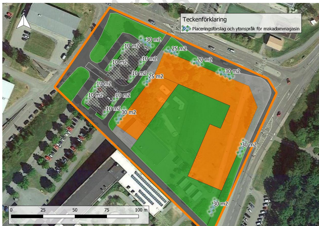
Figur 5:2. Schematisk bild över förslag på ytanspråk gällande dagvattenlösningar i form av makadammagasin för utredningsområdet. Notera att respektive magasin kan omlokaliseras så länge den totala fördröjningsvolymen bibehålls.
