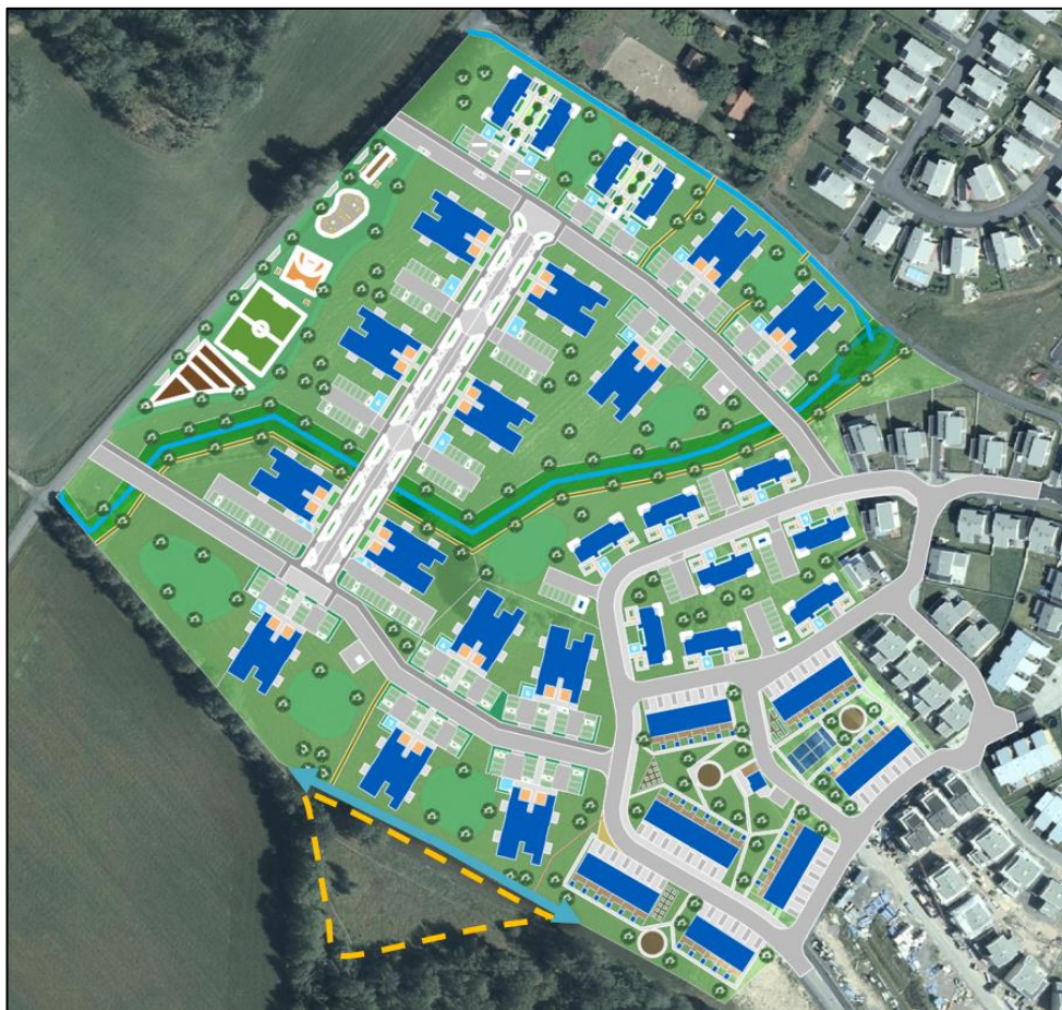
Figur 26. Aktuellt område som avvattnas in i planområdet där avskärande diken rekommenderas för att skydda bebyggelse.
