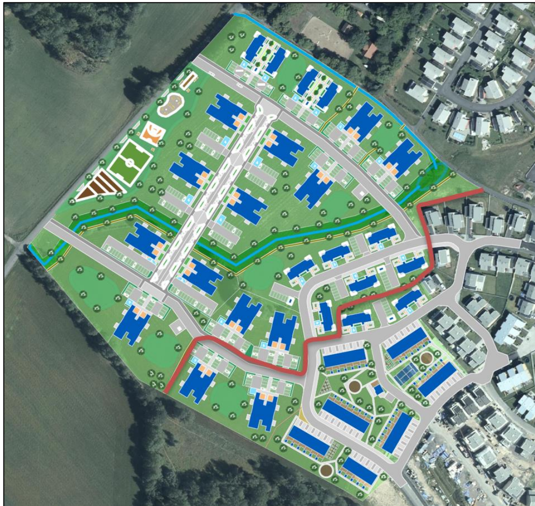
Figur 13. Ungefärlig indelning av planområdet. Vänster om röd avskärning leds dagvattnet till diket och höger leds dagvattnet till bostadsområdet i sydost och dess dagvattennät.
