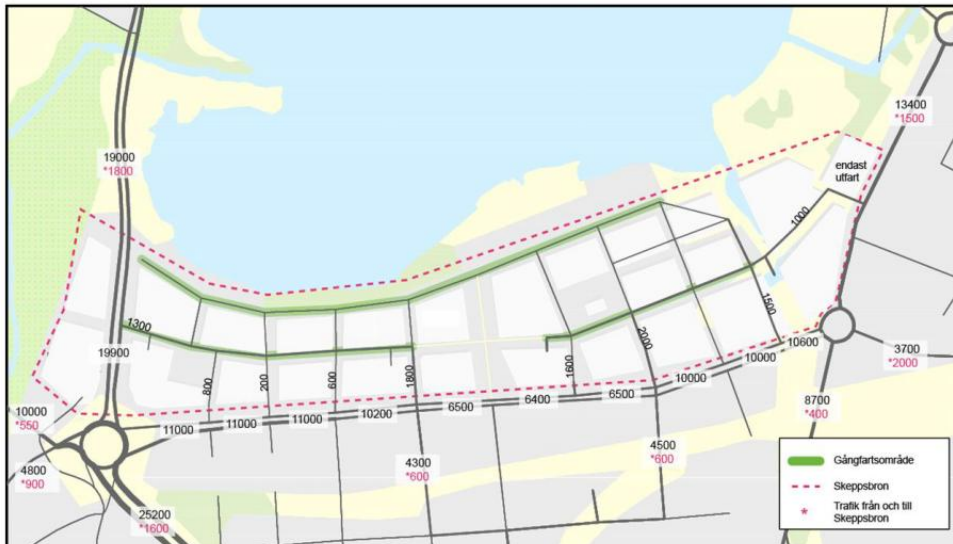
Figur 2 - Fördelning av trafik till och från Skeppsbron, utan ny bro över Munksjön. Svarta siffror visar det totala vardagsdygnsflödet på gatan och det röda flödet märkt med * visar hur mycket av detta som har sin start- eller målpunkt inom Skeppsbron.
