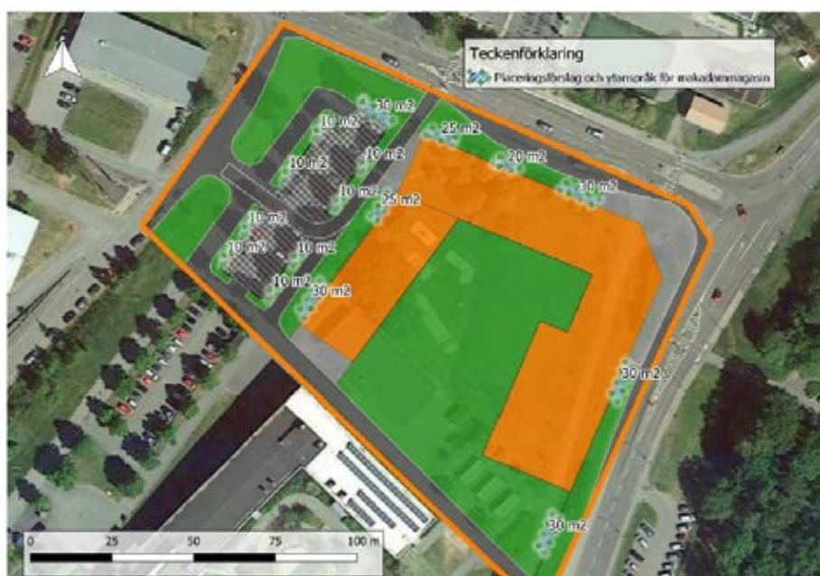
Det bästa alternativet bedöms vara att hantera dagvattnet med olika makadammagasin inom planområdets norra delar. Ovan bild visar på ungefärliga lägen, men respektive magasin kan omlokaliseras så länge den totala fördröjningsvolymen bibehålls. Det är även viktigt att den ytliga avledningssvängen söder om utredningsområdet blir kvar, så att vattnet söderifrån hindras från att rinna in på utredningsområdet, speciellt viktigt att beakta vid 100-års regn.
