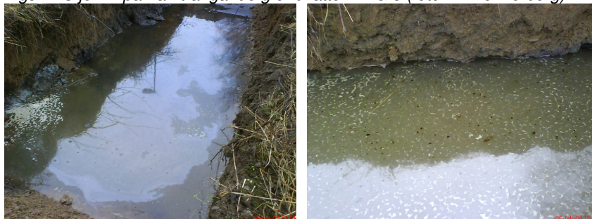
Figur 7 Oljefilm på framträngande grundvatten i PG 3 (foto: H Wennerberg)
