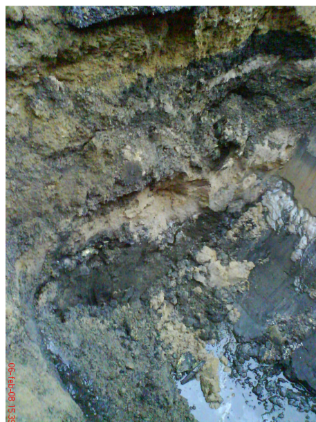
Figur 5 Tydliga skikt i provgrop i utfyllnadsområdet (foto: H Wennerberg)
