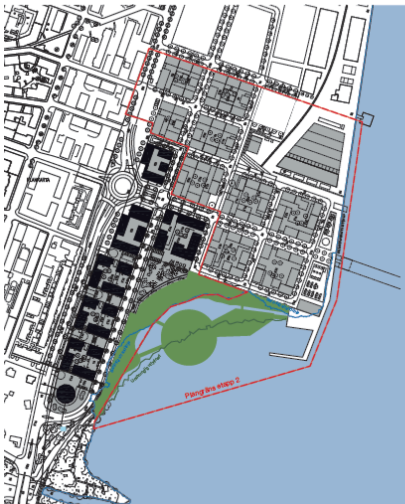
Figur 2. Det kommande planområdet illustreras med röd linje. I figuren visas även befintlig strandlinje, markyta för en tidigare planerad utfyllnad och nu föreslagna stabiliserande åtgärder och en flytande park.
