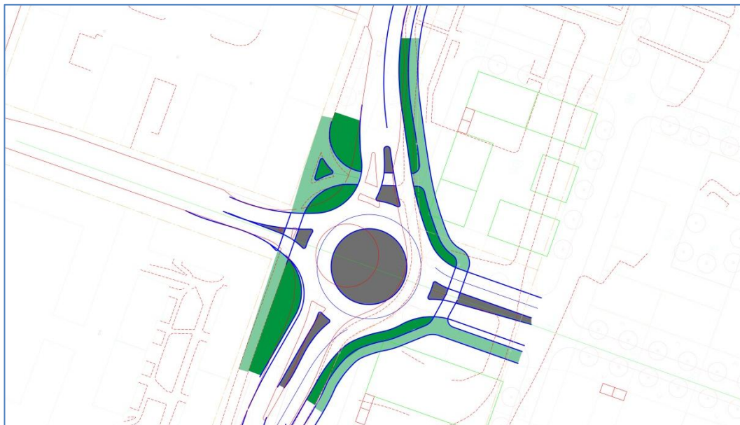
Figur 9 Principskiss för utformning av Barnarpsgatan - Torpagatan som 2-fältig cirkulationsplats
