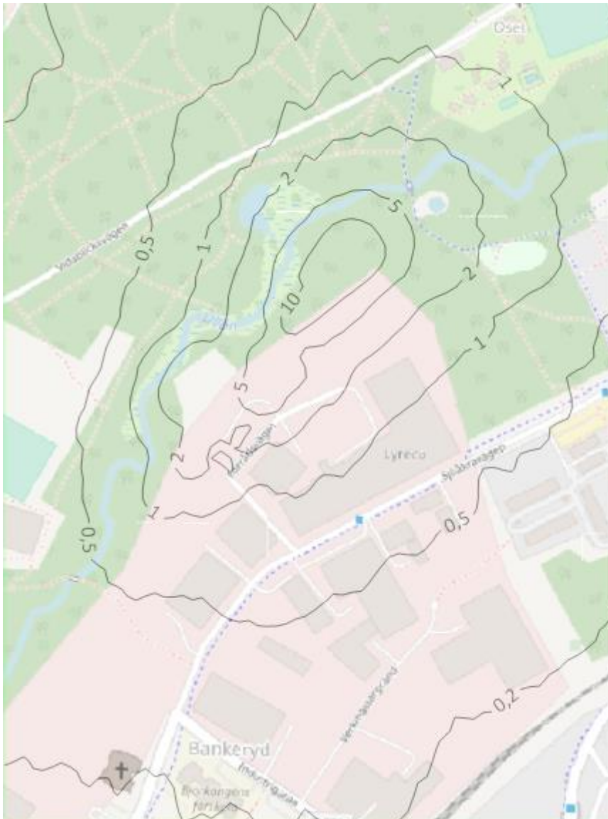
Figur 2 Spridningsberäkning av åtgärdsscenario 1 där luktconcentrationen ( \text{LE}/\text{m}^3 ) presenteras som 99e percentilen av minutmedelvärden beräknade från timmedelvärden
