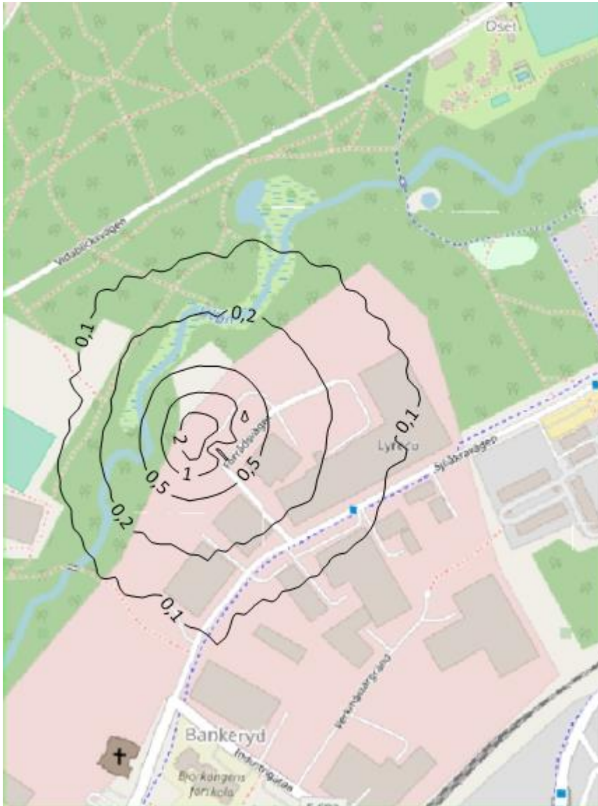
Figur 4 Spridningsberäkning av åtgärdsscenario 3 där luktconcentrationen ( \text{LE}/\text{m}^3 ) presenteras som 99e percentilen av minutmedelvärden beräknade från timmedelvärden.
