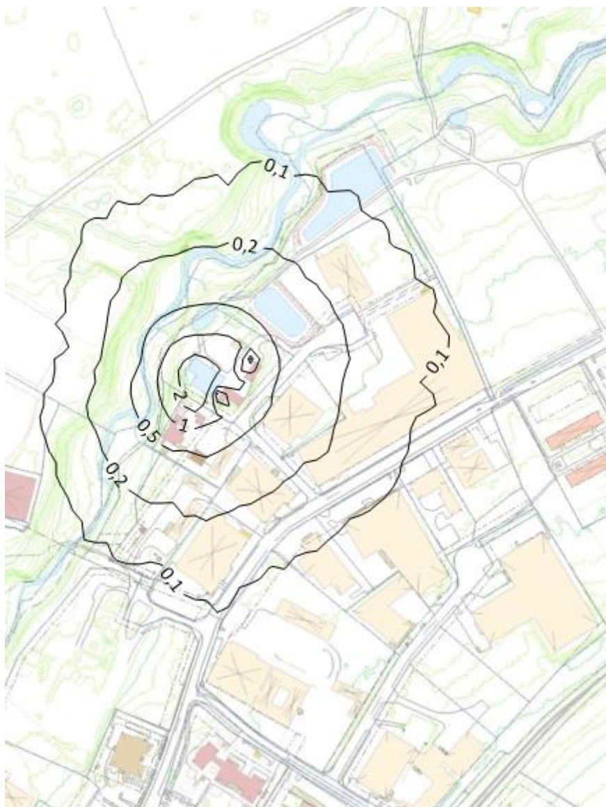
Figur 8 Spridningsberäkning av åtgärdsscenario 3 där luktconcentrationen ( \text{LE}/\text{m}^3 ) presenteras som 99e percentilen av minutmedelvärden beräknade från timmedelvärden. Riktvärdet som används i utredningen är 0,5 \text{ LE}/\text{m}^3 .
