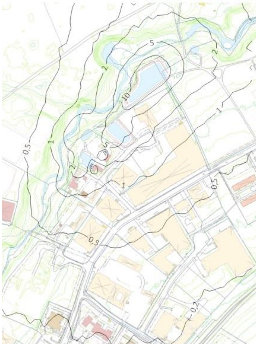
Figur 6 Spridningsberäkning av åtgärdsscenario 1 där luktconcentrationen ( \text{LE}/\text{m}^3 ) presenteras som 99e percentilen av minutmedelvärden beräknade från timmedelvärden. Riktvärdet som används i utredningen är 0,5 \text{ LE}/\text{m}^3 .
