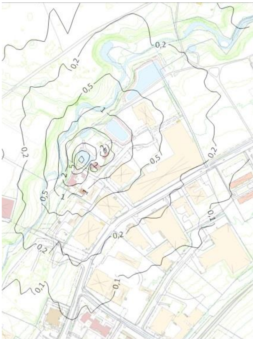
Figur 7 Spridningsberäkning av åtgärdsscenario 2 där luktconcentrationen ( \text{LE}/\text{m}^3 ) presenteras som 99e percentilen av minutmedelvärden beräknade från timmedelvärden. Riktvärdet som används i utredningen är 0,5 \text{ LE}/\text{m}^3 .
