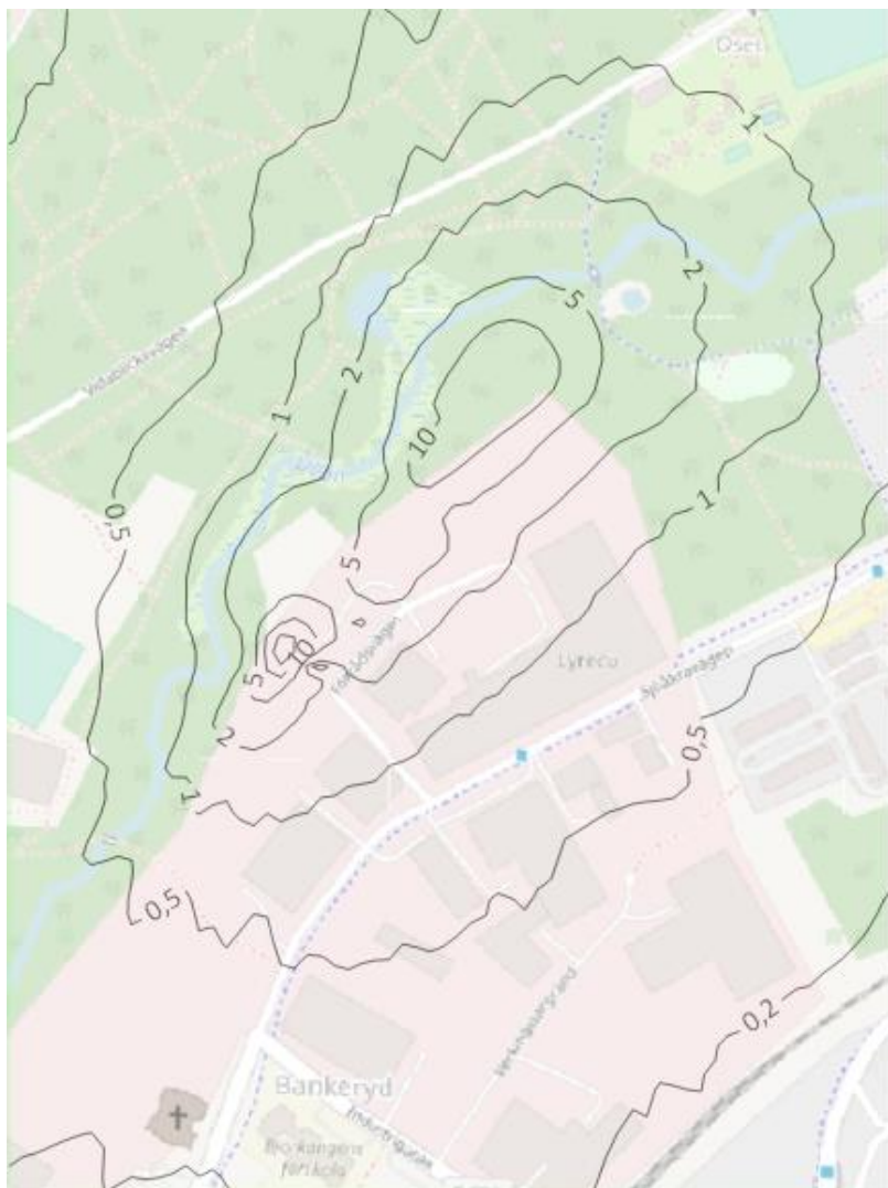
Figur 1 Spridningsberäkning av nuläges scenariot där luktconcentration ( \text{LE}/\text{m}^3 ) presenteras som 99e percentilen av minutmedelvärden beräknade från timmedelvärden
