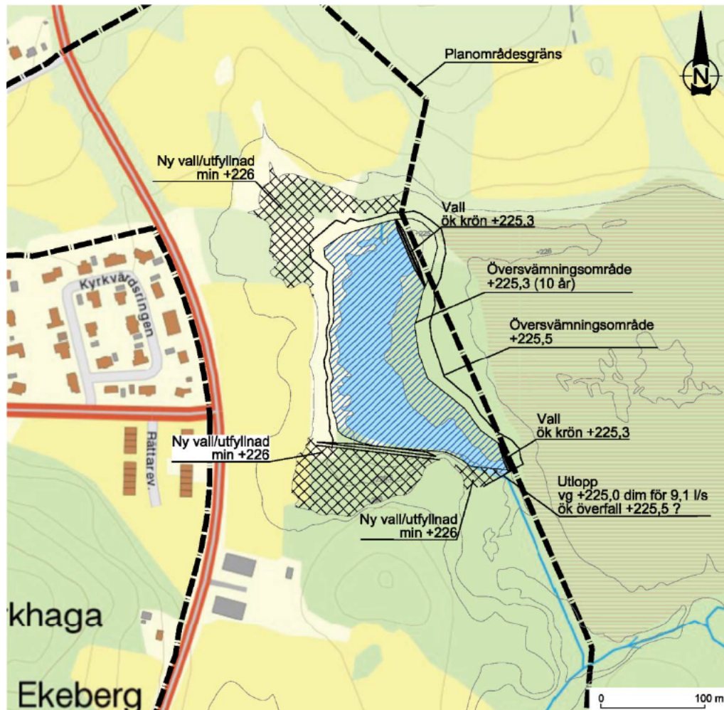
Figur 10. Principförslag på utformning och nivåsättning av våtmarken.
