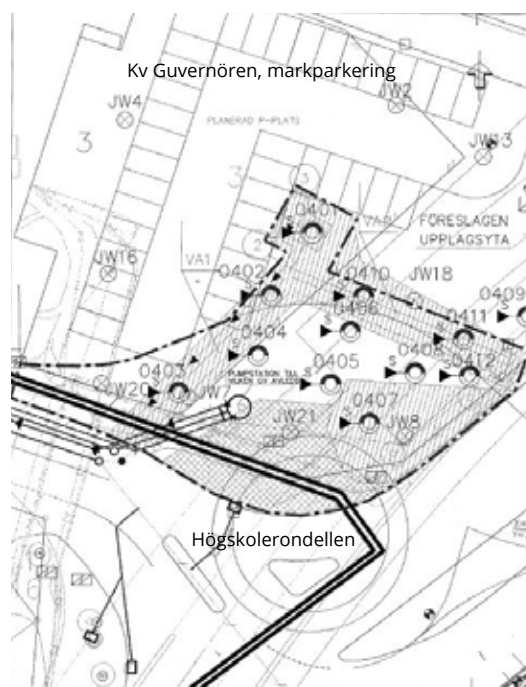
Figur 70 B provtagningspunkter, se utredningen Kv Guvernören, Sanering av PAH-förorenad jord i samband med anläggande av Va-ledning, pumpstation samt trafikplats, Jönköping 2005-01-17, SWECO VIAK AB. Länsstyrelsens Dnr 575-1164-05
