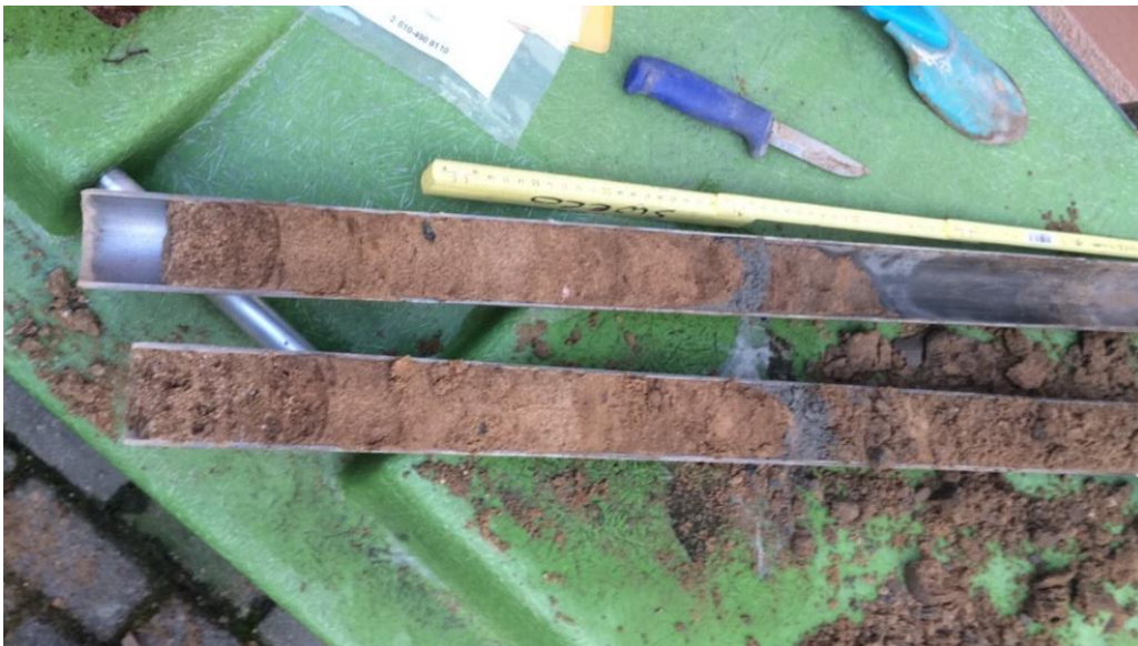
Fig. 1. Jordkärna uttagen med hjälp av borring, typ mullvad.
