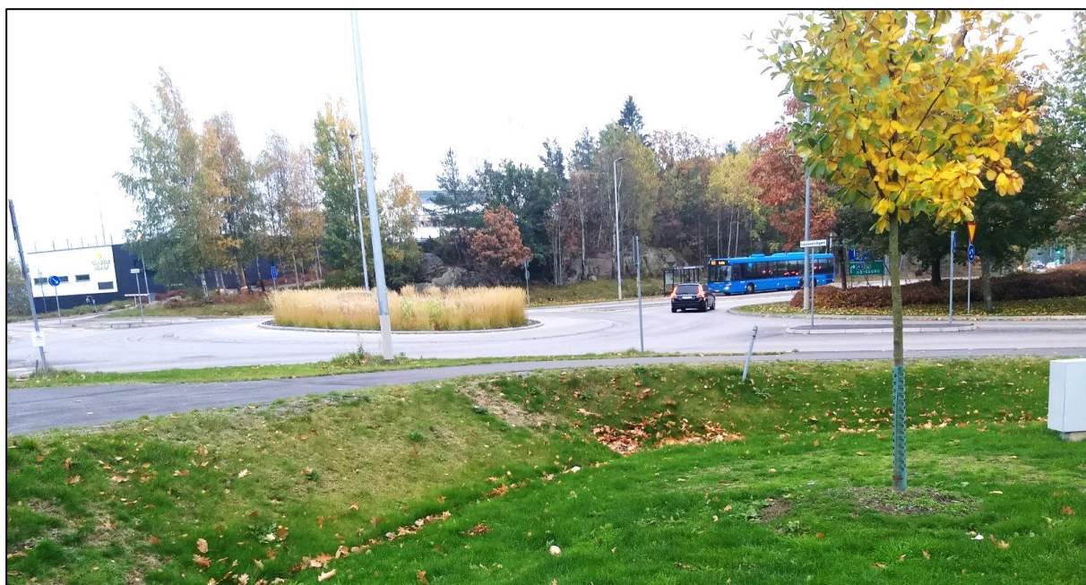
Figur 12. Exempel på svackdike.
