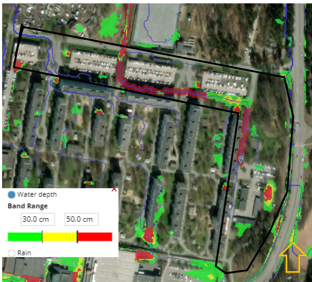
Figur 27. Översikt lågpunkter med vattendjup som varierar mellan 0,3-0,5 m i samband med ett 100-årsregn, samt rinnvägar för skyfallet från Övermannen 20 och Övermannen 21 (Scalgo Live, 2020).
