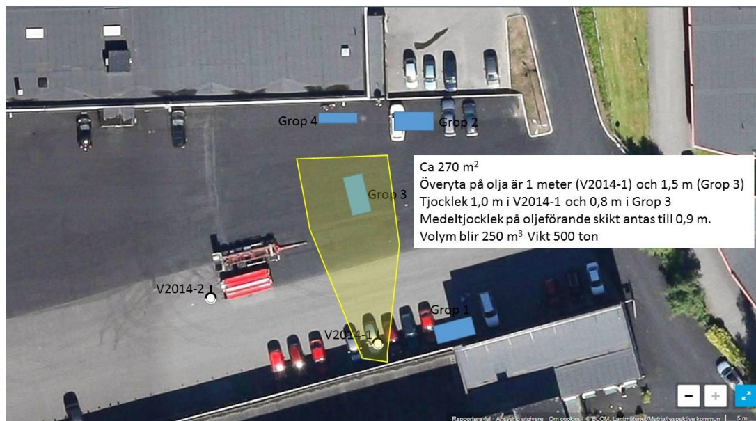
Figur 2 Provgropar på parkeringen samt avgränsning av olja i marken.
