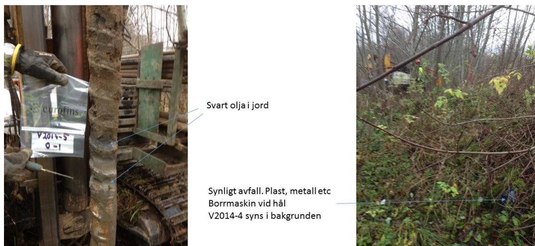
Figur 2 Rester av olja i marken och avfall på södra sidan av Valplatsen 2.
